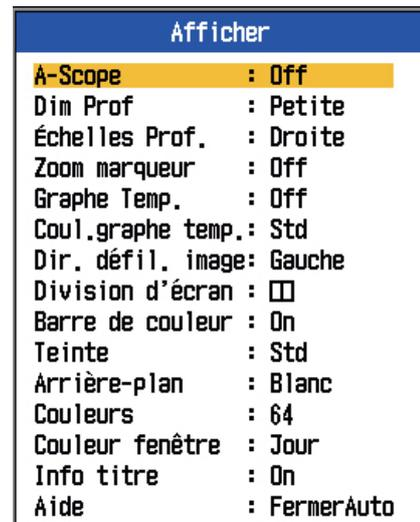
3. Utilisez les flèches ▲ et ▼ pour sélectionner A-Scope et appuyez sur la touche **ENTER**.
