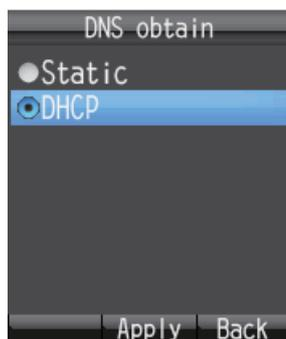
17. Pulse ▲ o ▼ para seleccionar el método por el que desea obtener la dirección del servidor DNS.
