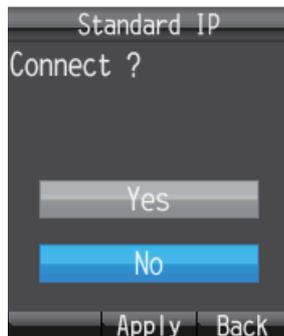
3. Pulse **▲** para seleccionar [Yes] y, a continuación, pulse la tecla **Enter**. Mientras se está estableciendo la conexión, aparecerá el mensaje "Connect...". Cuando se haya conectado, aparecerá el mensaje "Completed".
