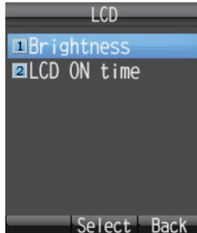
2. Pulse **1** para seleccionar [Brightness] a fin de que aparezca la pantalla habilitada para ajustar la intensidad del brillo.
