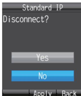
3. Pulse **▲** para seleccionar [Yes] y, a continuación, pulse la tecla **Enter**. Durante el proceso de desconexión, aparecerá el mensaje "Disconnect..." y, cuando dicho proceso haya finalizado, aparecerá el mensaje "Completed."
