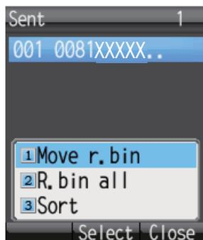
4. Para mover un único mensaje a la papelera de reciclaje, pulse la tecla **1** para seleccionar [Move r. bin]. Por el contrario, si desea mover todos los mensajes de una carpeta determinada, pulse la tecla **2** para seleccionar la opción [R. bin all]. Aparecerá el mensaje "Moving..." durante la transferencia y el mensaje "Moved" cuando ésta haya finalizado.
