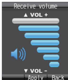
2. Pulse ▲ para subir el volumen o ▼ para bajarlo. Pulse la tecla **Enter** para ajustar el volumen o espere dos segundos para que se ajuste automáticamente.
