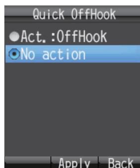
3. Pulse **▲** o **▼** para seleccionar la configuración de Off Hook:
