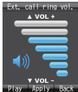
3. Pulse **▲** o **▼** para ajustar el nivel del volumen (0 - 7). Ajústelo en [0] para desactivar el sonido.
