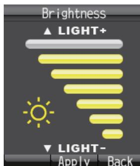
3. Pulse ▲ o ▼ para aumentar/disminuir el nivel de intensidad del brillo del LCD.
