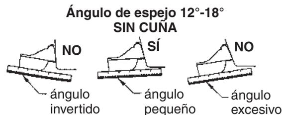
*Posición del sensor y ángulo del espejo*
