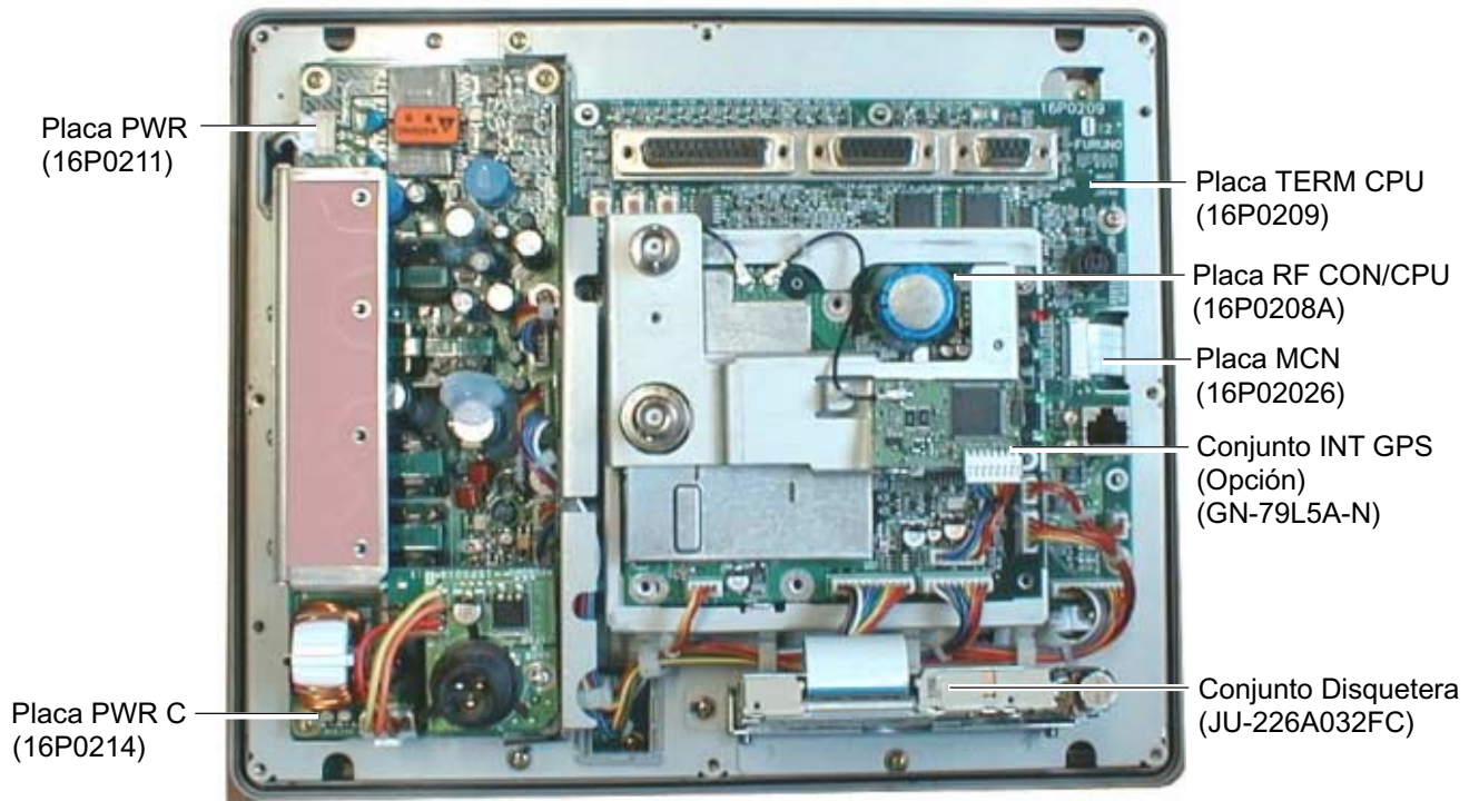
Unidad Terminal, vista interior
