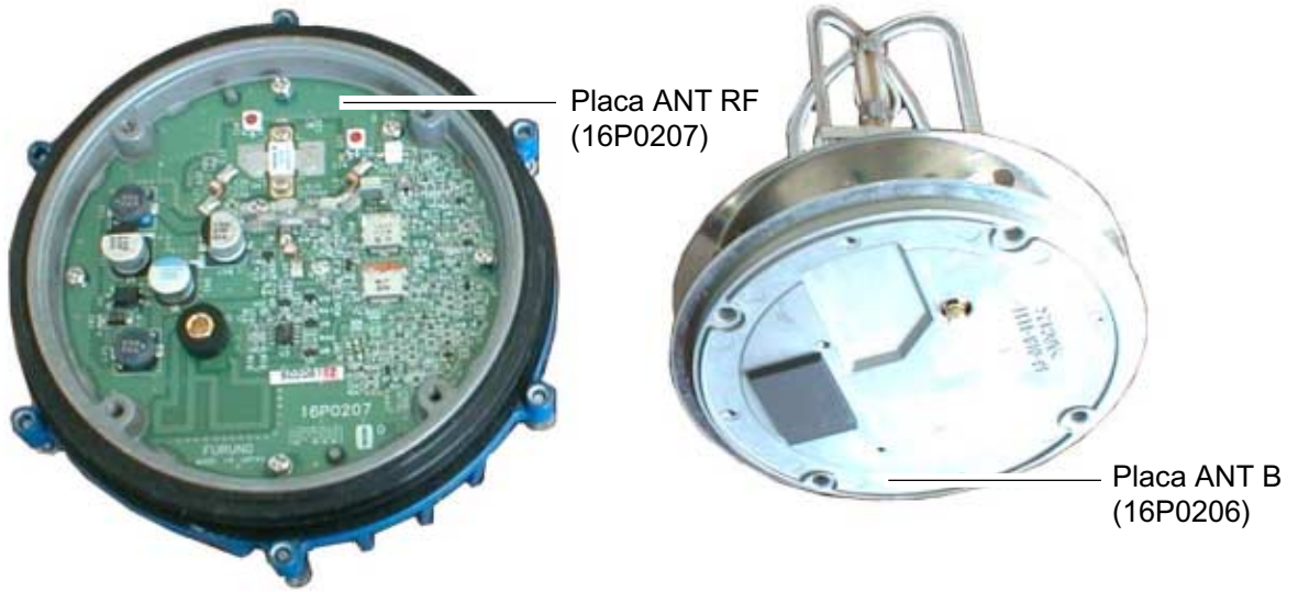
Unidad de Antena, con la cubierta abierta
