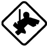
**Usar cinturón de seguridad y casco cuando se trabaje en la unidad de antena.**
