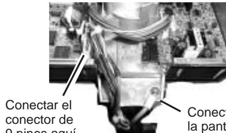
*Conexión de la pantalla del cable de antena a tierra*
