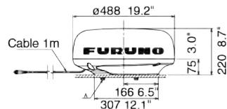
Radomo de 24" Sensor de radar DRS4D-NXT 7,3 kg 16,1 lb
